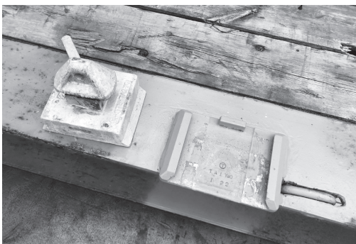
脱着可能なツイストロックを設置
