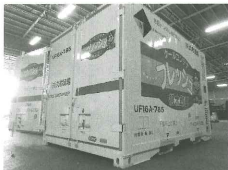
隅金具を設置した新型UF16Aコンテナ
